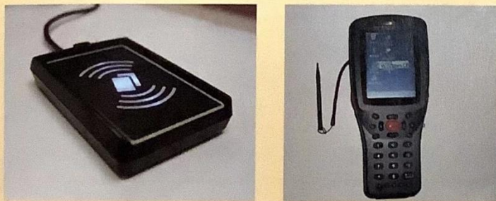
图19-6 各种类型的读写器
