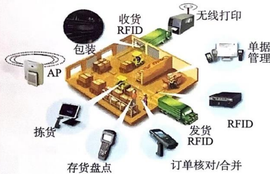
图19-2 智慧仓储的系统构成
