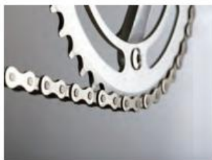
图 6.1-2 自行车的齿轮与链条
