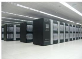
在 2010 年全球超级计算机排行榜中，中国首台千万亿次超级计算机系统“天河一号”雄居第一，其实测运算速度可以达到每秒 2 570 万亿次。
